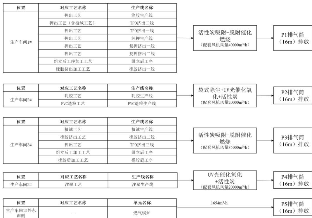
图 2.4-1 本项目废气收集及处理示意图
